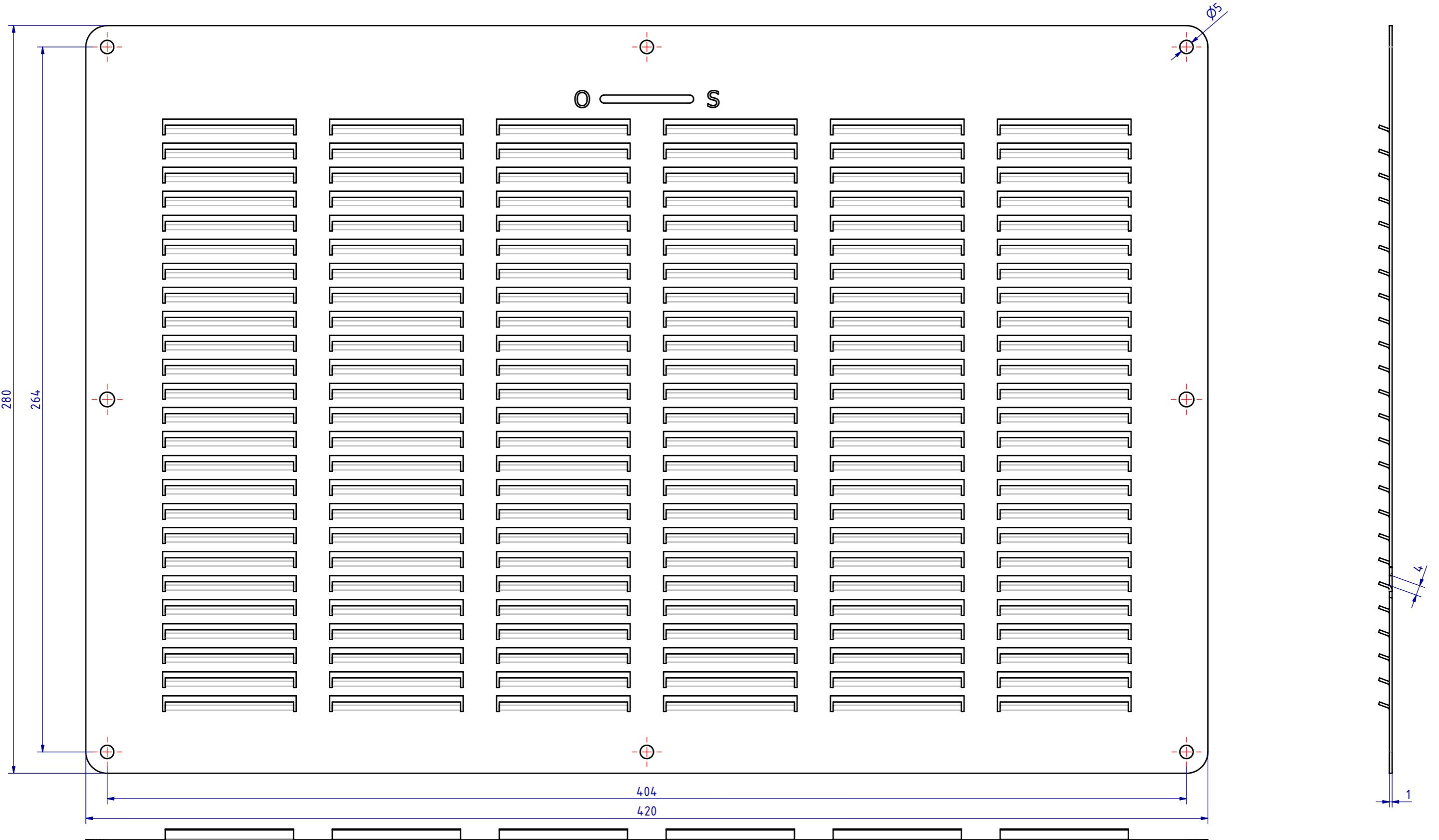
113908 Lüftungsblech Luftdurchlaß 300 Cm<sup>2</sup>
