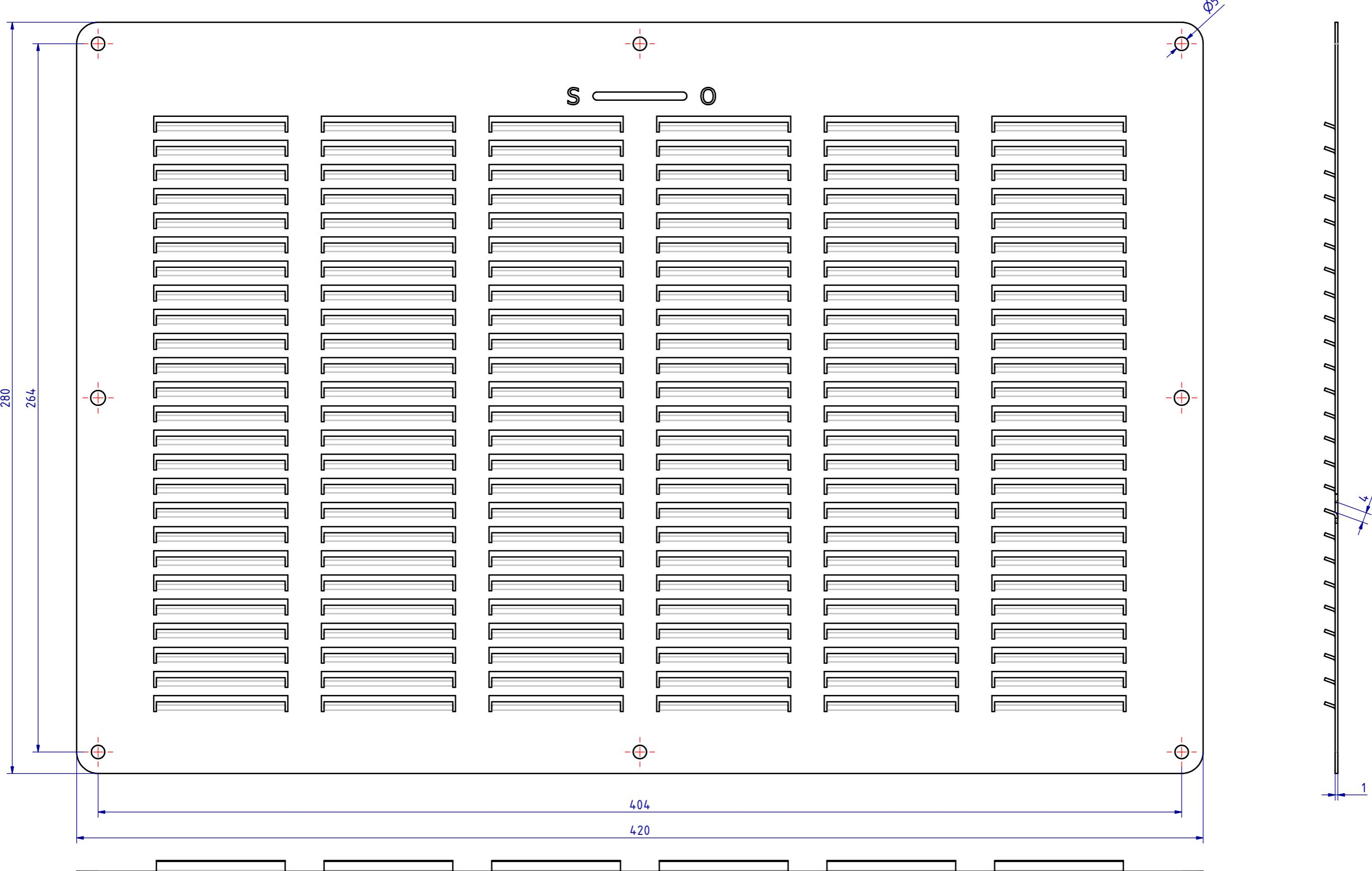
106212 Lüftungsblech Luftdurchlaß 300 Cm<sup>2</sup>
